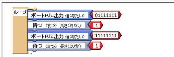
※、電流を頻繁に ON-OFF する制御を PWM 制御といい、扇風機の回転速度の変換や、照明器具の明るさ調整などに使われています。
